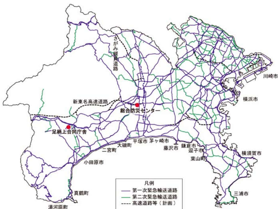
図 13 災害に備えた道路ネットワーク
