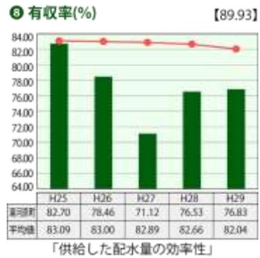
有収率とは、施設の稼働が収益につながっているかを判断する指標です。この指標は、100%に近ければ近いほど施設の稼働状況が収益に反映されていると言えます。数値が低い場合は、水道施設や給水装置を通して給水される水量が収益に結びついていないため、漏水やメーター不感等といった原因を特定し、その対策を講じる必要があります。本町では直近3年で数値が低下しており、漏水やメーター不感など原因を解消していく必要があります。
