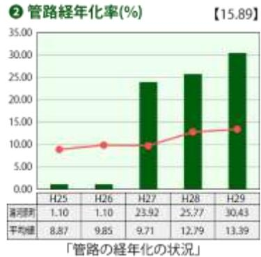
管路経年化率は、法定耐用年数を越えた管路延長の割合を表す指標で、管路の老朽化度を示しています。この指標は、一般的に、数値が高い場合は、法定耐用年数を経過した管路を多く保有しており、管路の更新等の必要性を推測することができます。本町では平成27(2015)年より急激に数値が増えており、老朽管が増大していることがわかります。
